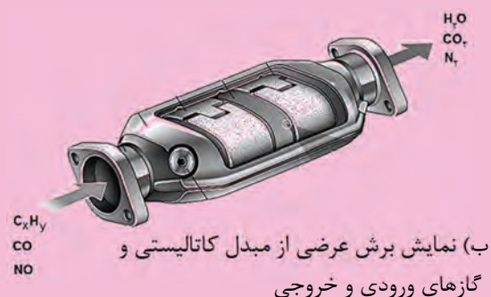
الف) مبدل کاتالیستی و جایگاه آن در خودرو مبدل کاتالیستی در خودرو
